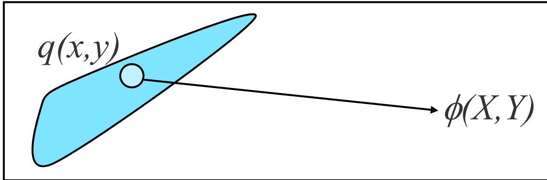
$$\phi(X, Y) = \int_{-\infty}^{+\infty} \int_{-\infty}^{+\infty} G(X - x, Y - y) q(x, y) dx dy$$
